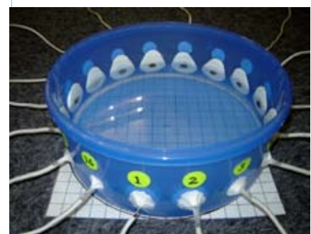
→ 3. Test set-up for the EIT system.
